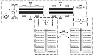
CLOCK TREE EXAMPLE USING 2 LEVEL HIERARCHICAL BUS
